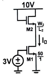
For M1 Sat :  $V_{DS1} \geq V_{GS1} - V_{TN}$
